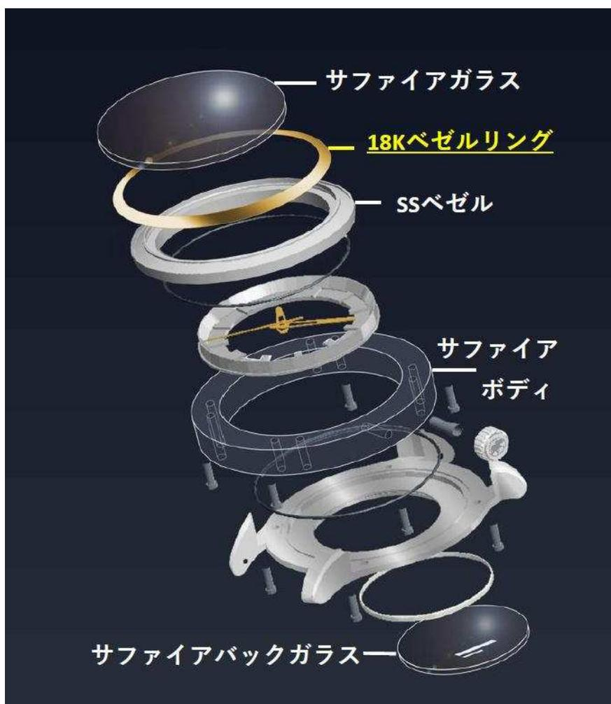
モース硬度 9 のサファイアクリスタルは、地球上に存在する素材としては、モース硬度 10 のダイヤモンドの次に硬い宝石。一般的なガラスの硬度が 5~6 といわれ、差は歴然で擦りキズに強く、透き通った清楚な外観が最大の魅力と言えます。それゆえ時計のケースを製造する過程は困難を極め、加工にも硬度の高いダイヤモンド研磨機という機械で何時間も加工をする必要があります。
