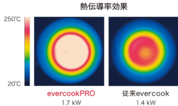
アルミニウム製加熱調理器具 入力電力試験
