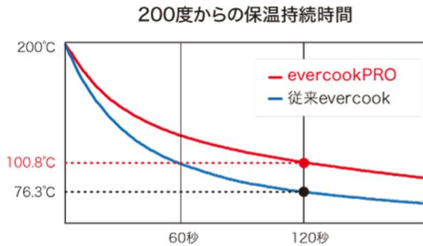
電磁調理器 (IHクッキングヒーター)にて200度からの保温持続時間試験
